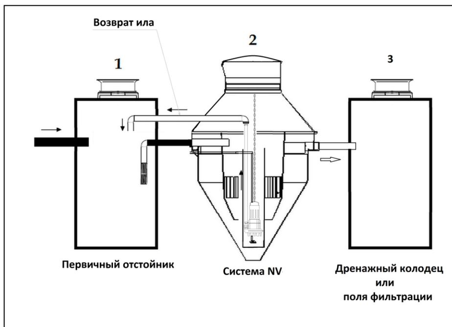
Первичный отстойник делает данную станцию еще более надежной при эксплуатации. В нем задерживается все - плавающий мусор, жиры, песок, туалетная бумага. Наши специалисты могут произвести модернизацию станции, настроив автоматическую откачку ила в первичный отстойник. В этом случае станция будет всегда чистой и готовой к обработке новых стоков.
